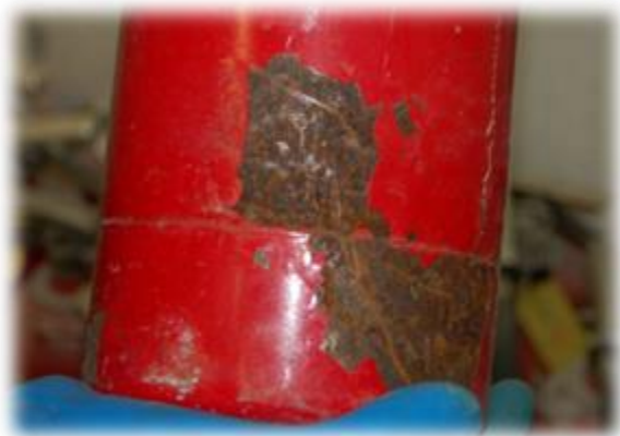
54.att. Korpusa korozijas bojājumi
