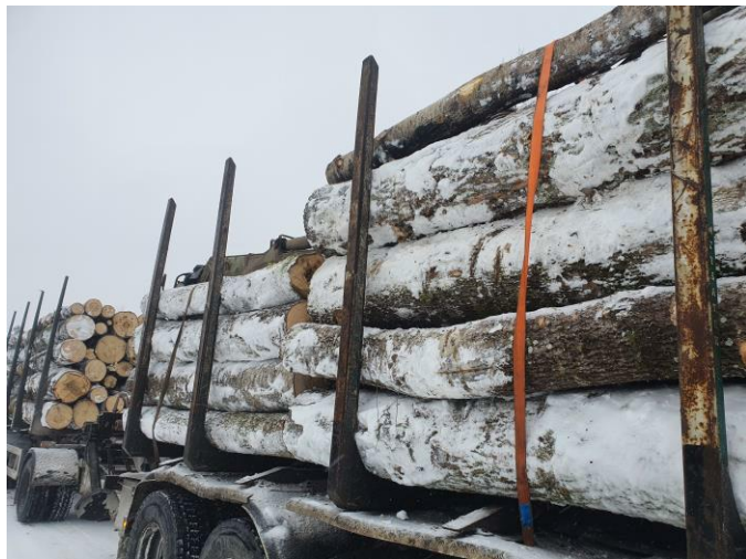
44.att. Kok vedējautomašīnas kravas nostiprināšana.
