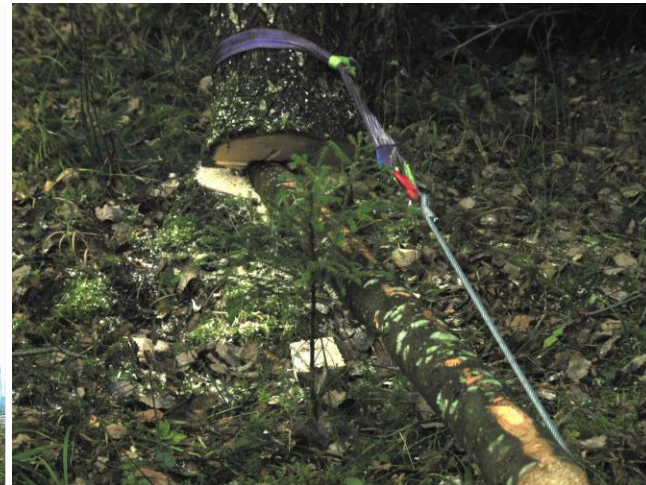
38.att. Palikņa izmantošana iekāruša koka atvieglotai novilkšanai
