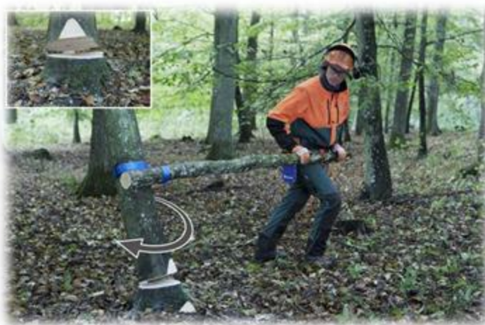
35.att. Koka nošūpošana, izmantojot sviru ar speciālu saiti
